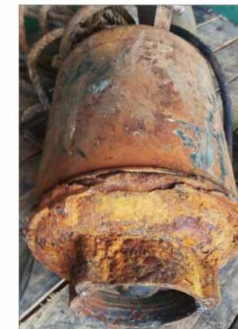
Después de cinco meses de funcionamiento, la corrosión se ha reducido (ver foto inferior) mientras que el ánodo de sacrificio ha desaparecido. Recomendación: Reemplace el Ánodo de Sacrificio cuando este esté gastado en sus 3/4 partes.
